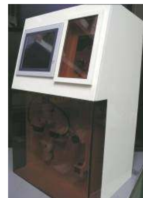
銅濃度管理装置
